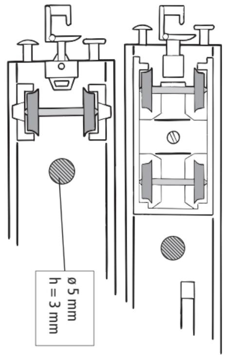
**Schaltmagnet zur Betätigung der Schaltkontakte 6425, 6435, 9425 bzw. des Schaltgleises**
